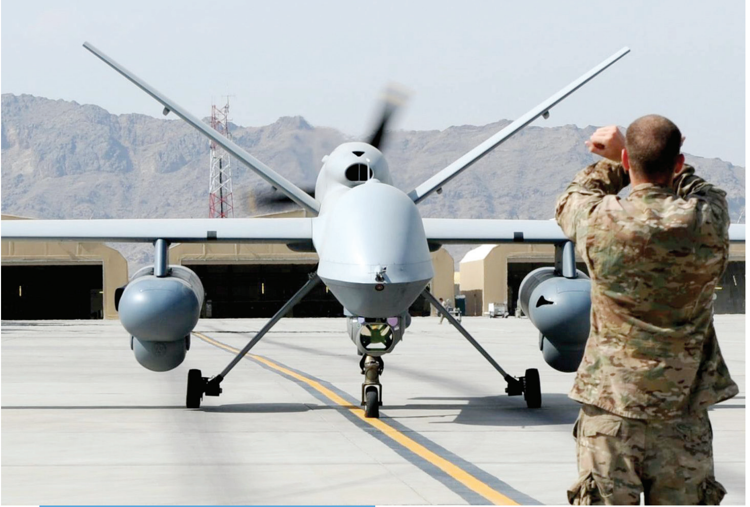
طائرة بدون طيار مجهزة بحاويات استطلاع إلكتروني
